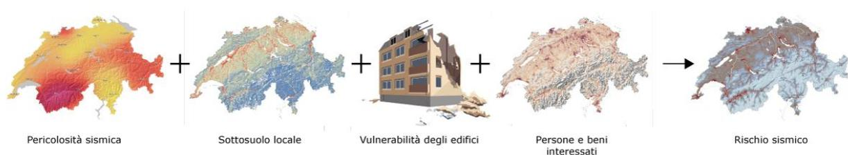
**Figura 20** Componenti per determinare il rischio sismico.
