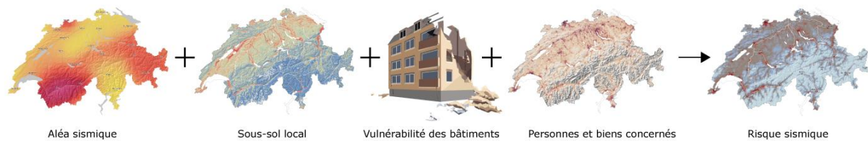
Figure 3 : Les quatre facteurs de détermination du risque sismique. Remarque : il existe également d'autres définitions pour les différents termes (p. ex. « exposition » pour les personnes et les biens concernés).
