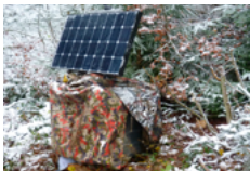
Solarbetriebene temporäre Messstation beim Geothermieprojekt in St. Gallen
